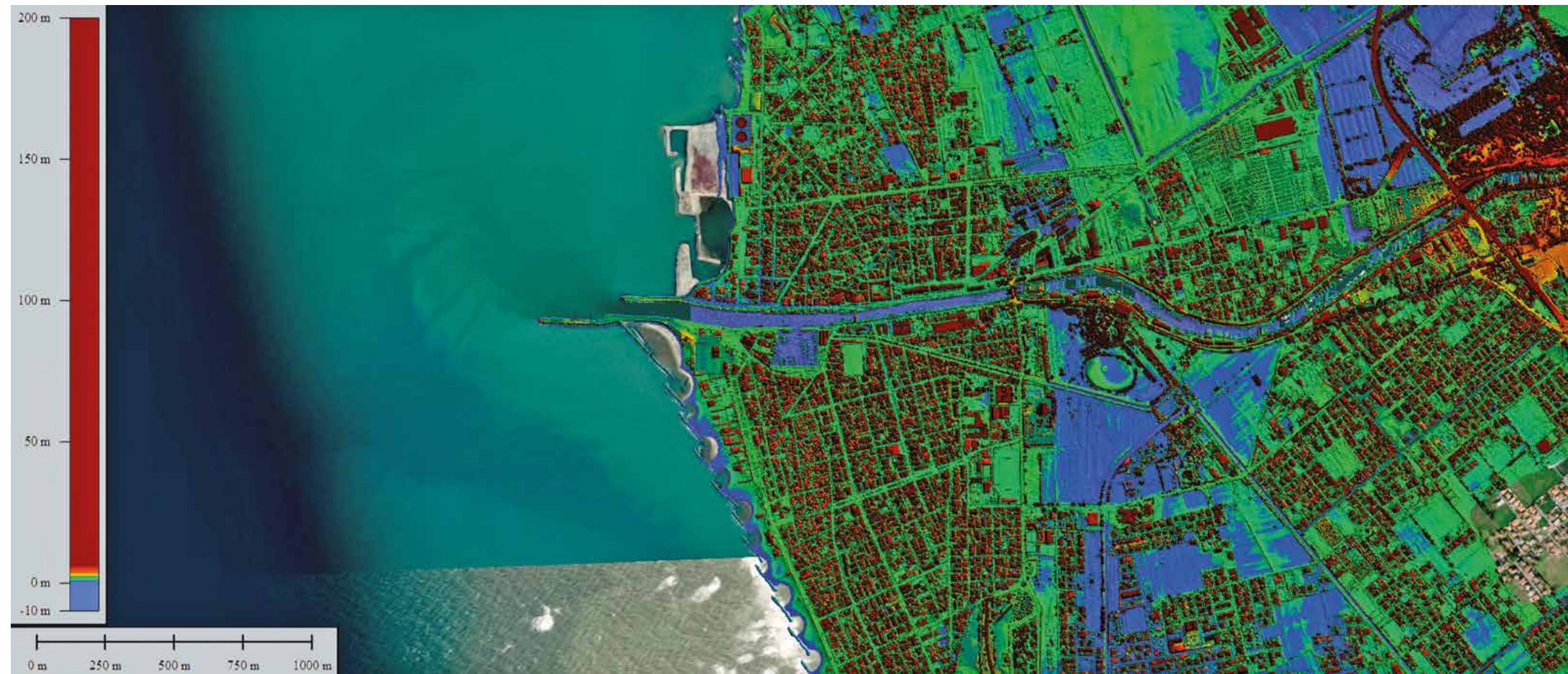
FIG. 7. SCREENSHOT DEL SOFTWARE GLOBAL MAPPER CON ELABORAZIONE DI SCENARIO DI AUMENTO DI LIVELLO MARINO FINO AL 2150 PER IL PORTO CANALE DI FIUMICINO, SECONDO LA PROIEZIONE CLIMATICA DEL RAPPORTO AR6 DELL'IPCC (2021), CORRETTO PER LA VELOCITÀ DI SUBSIDENZA ATTUALE CALCOLATA DAL COPERNICUS GROUND MOTION SERVICE (TOPOGRAFIA AD ALTA RISOLUZIONE DEL MASE)
