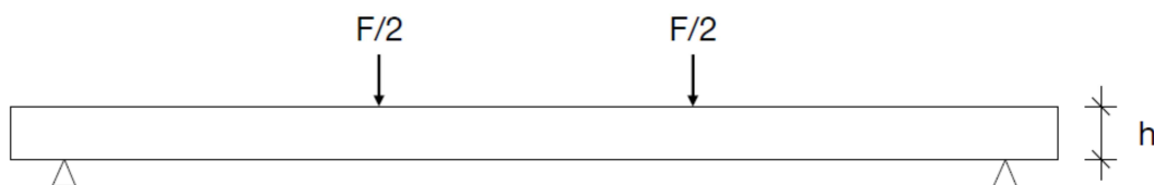
Fig. 1 – metodo di prova per elementi caratterizzati da classi di resistenza C con valori a flessione parallela alla fibratura superiori a 30 N/mm 2 (UNI EN 408 – semplificata)
