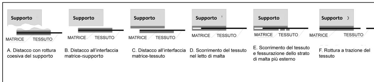
**Figura 2 – Meccanismi di crisi**
